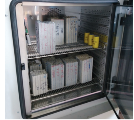
Hızlandırılmış karbonatlaşma için prizmalara sahip iklim odası (İsviçre SIA 262/1-X standardı)
